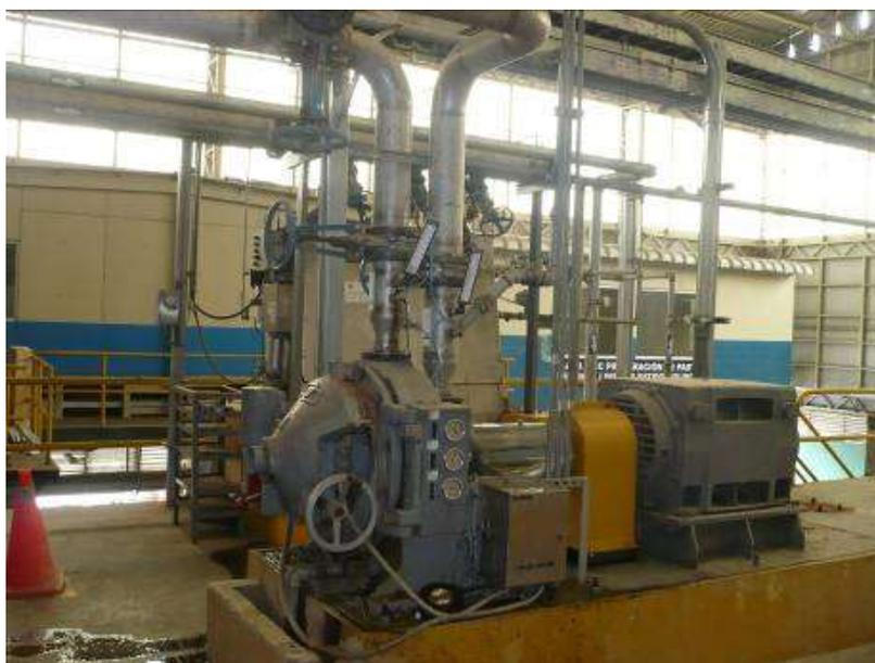
**FIGURA 2.9 REFINADOR DE FIBRA CORTA (INSTALACIÓN FINAL)**
