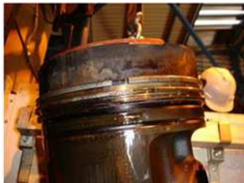
FORMACIÓN DE LACAS EN PISTÓN POR ALTA TEMPERATURA (TERMO-OXIDACIÓN)
