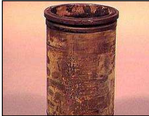
Figura 1.22 Desgaste por Cavitación.
