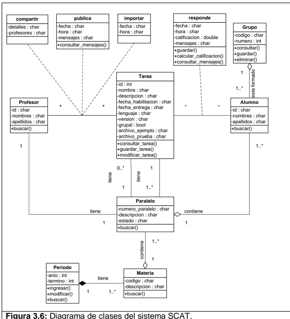
**Figura 3.6:** Diagrama de clases del sistema SCAT.
