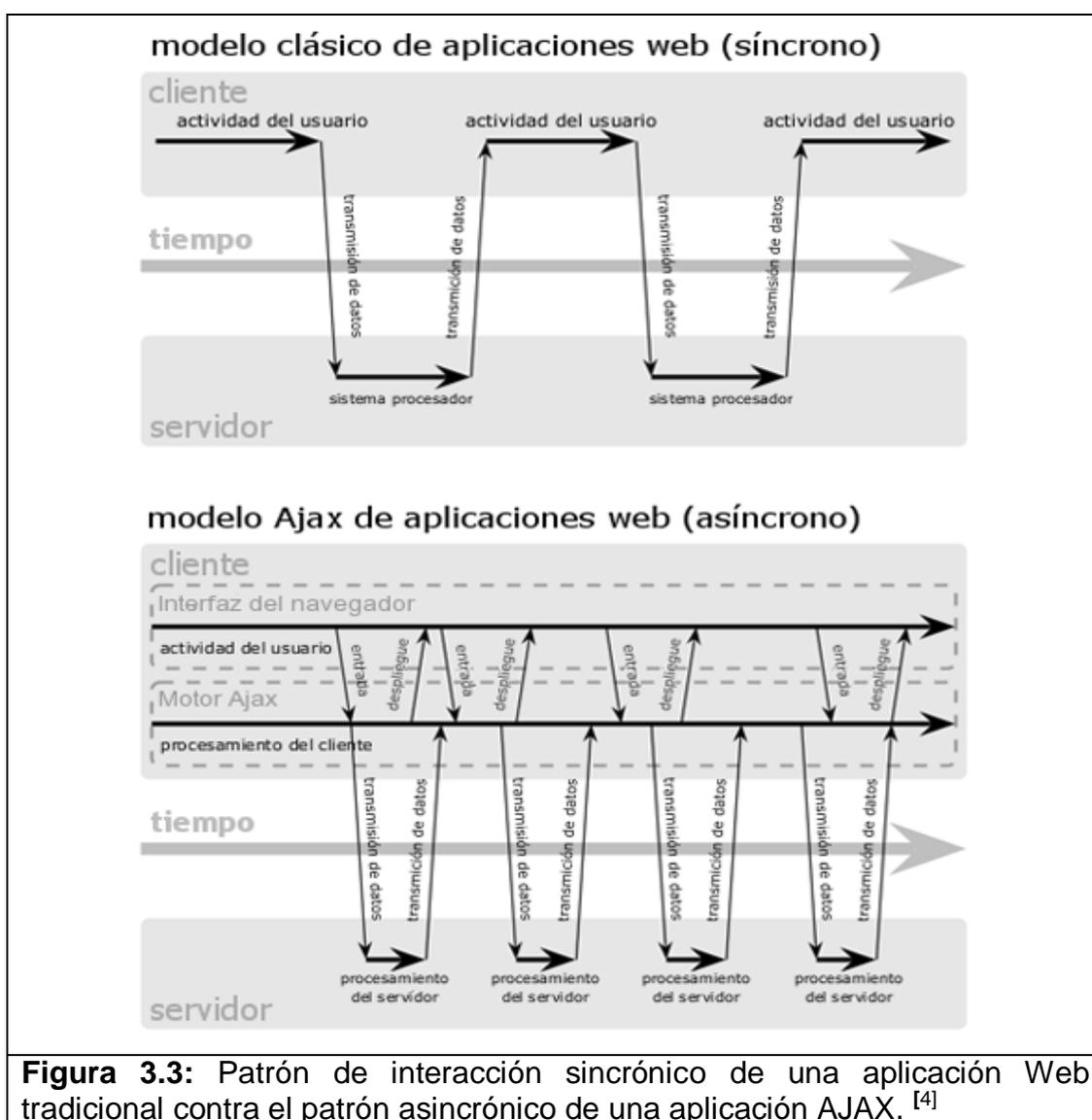
**Figura 3.3:** Patrón de interacción síncrono de una aplicación Web tradicional contra el patrón asíncrono de una aplicación AJAX. [4]
