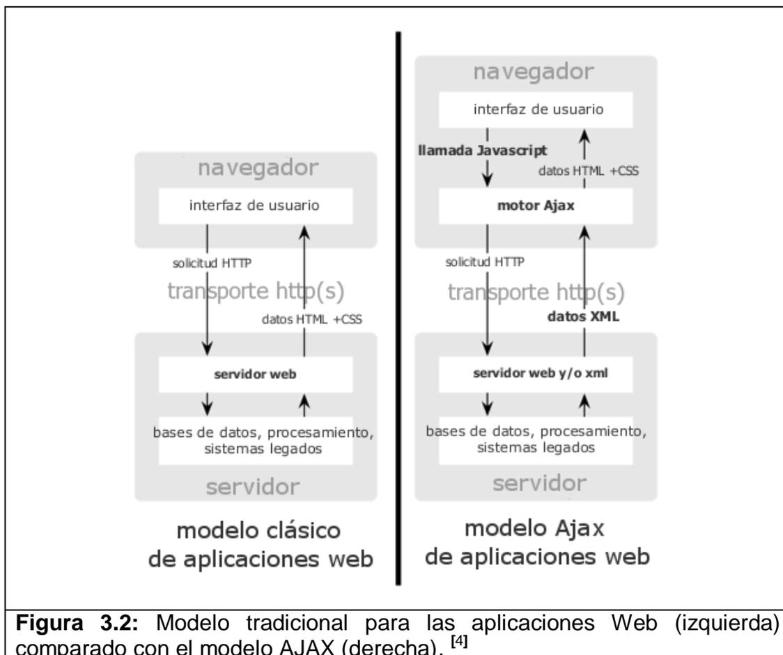
Cada acción de un usuario, que normalmente generaría un requerimiento HTTP, toma la forma de un llamado JavaScript al motor AJAX en vez de ese requerimiento. Cualquier respuesta a una acción del usuario que no requiera un viaje de vuelta al servidor (como una simple validación de datos, edición de datos en memoria, incluso algo de navegación) es manejada por su cuenta. Si el motor necesita algo
