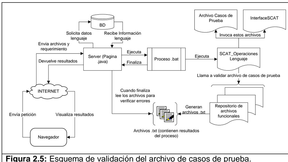
**Figura 2.5:** Esquema de validación del archivo de casos de prueba.
