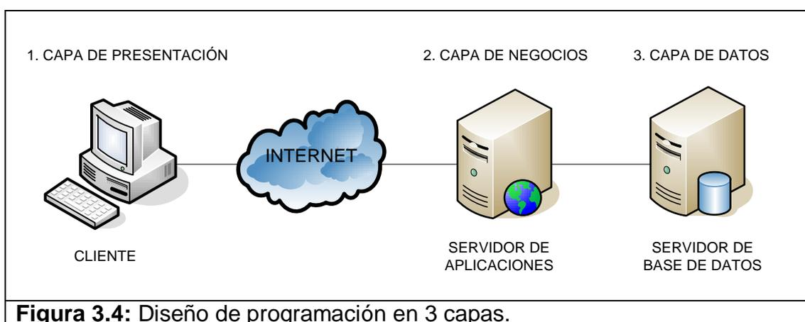
**Figura 3.4:** Diseño de programación en 3 capas.
