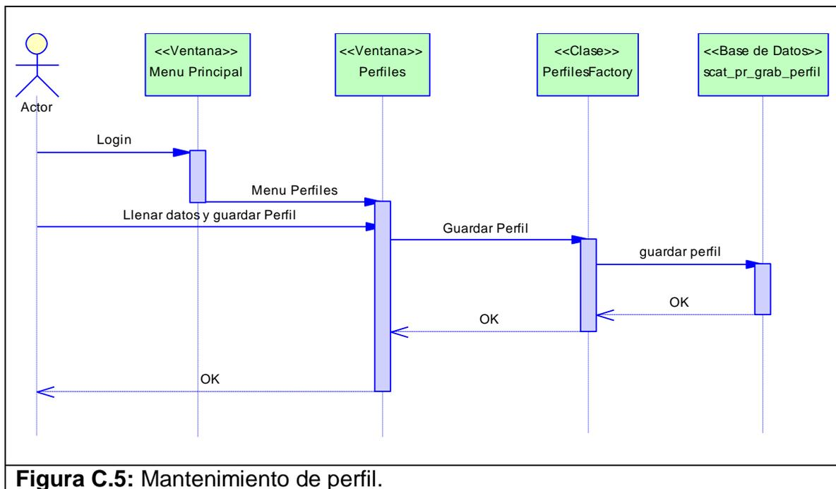
**Figura C.5:** Mantenimiento de perfil.
