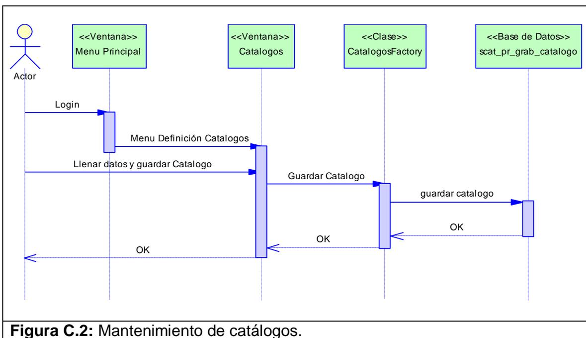
Figura C.2: Mantenimiento de catálogos.
