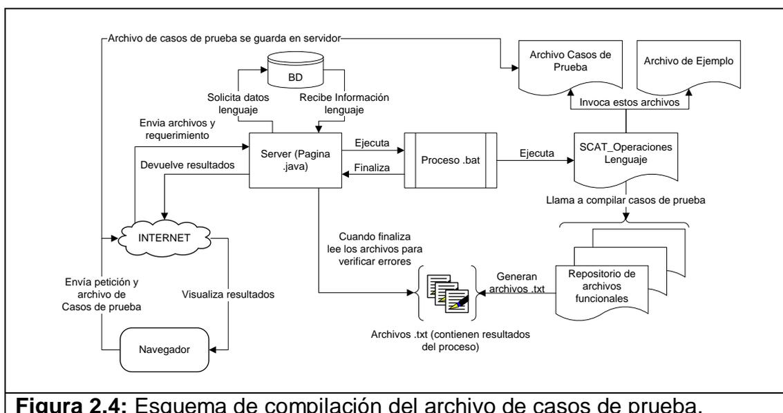
**Figura 2.4:** Esquema de compilación del archivo de casos de prueba.
