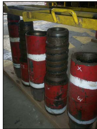
Figura 9.- Junta de Seguridad, Compañía Weatherford.
