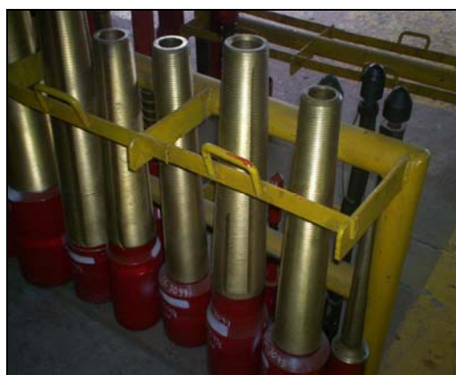
Figura 2.-Pescante Rabo de Rata, Compañía Weatherford.
