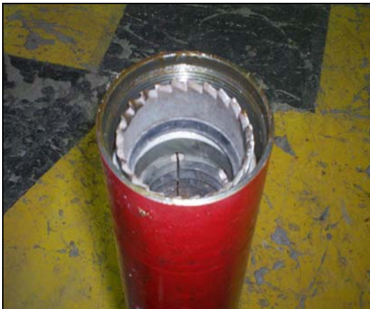
Figura 3.- Pescante de Enchufe, Compañía Weatherford.
