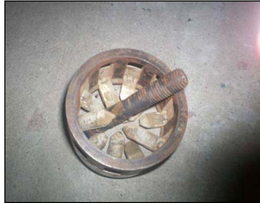
Figura 6.- Cesta Recuperadora de Desperdicios, Compañía Weatherford.
