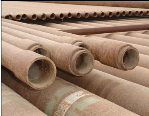
Figura 10.-Tubería de 2 7/8 de pulgada utilizada para la extracción de petróleo en los métodos de Bombeo Mecánico y Pistoneo de Swab.
