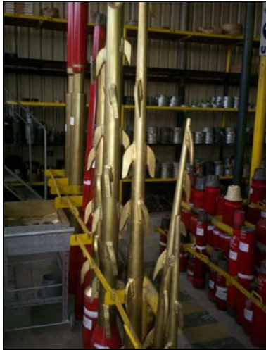
Figura 7.- Arpón para Cables, Compañía Weatherford.
