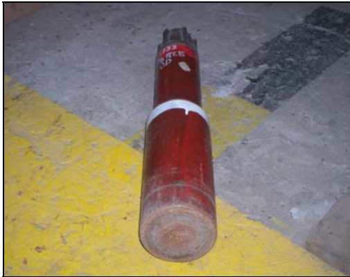
Figura 5.- Pescante Magnético, Compañía Weatherford.
