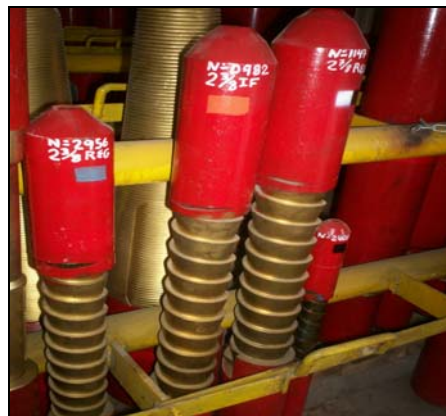
Figura 4.- Pescante Arpón, Compañía Weatherford.
