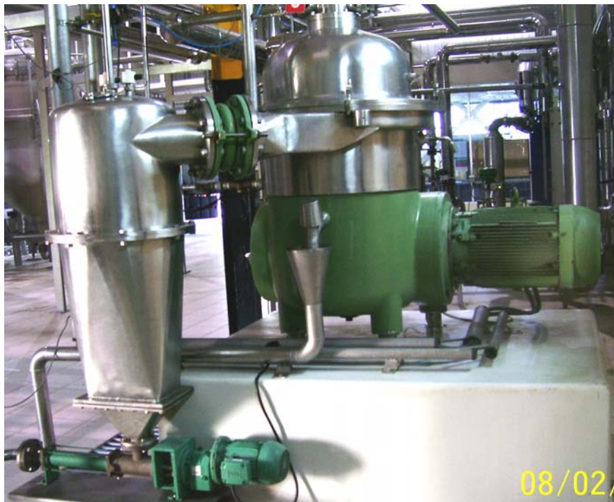
FIGURA 1.11 Equipo de centrifugación de cerveza
