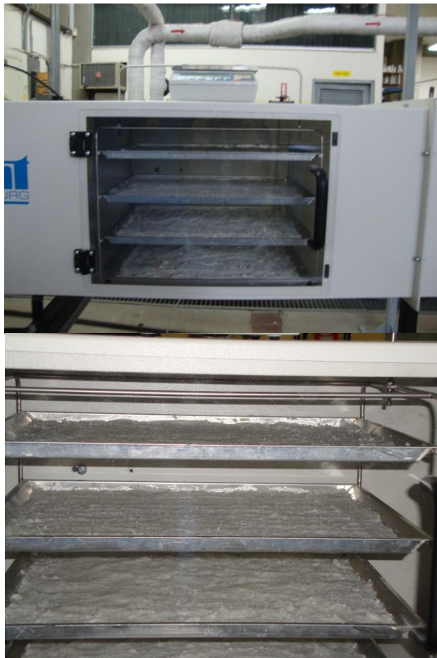
FIGURA 2.1. SECADO DEL ARROZ EN EL SECADOR MARCA GUNTAMBURG
