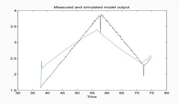
Comparación del modelo con la planta real
