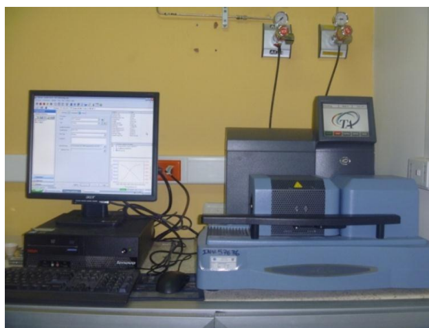
FIGURA 3.21 EQUIPO TÉRMICO GRAVIMÉTRICO.
