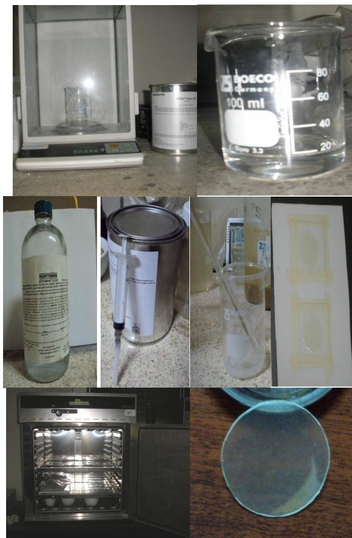
FIGURA 3.17. PREPARACION DEL COMPUESTO TRADICIONAL
