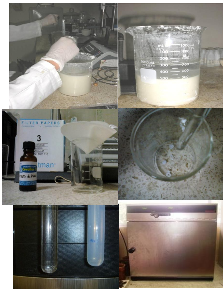
FIGURA 3.15. PROCEDIMIENTO DE LAVADO DE LAS NANOARCILLAS Y SECADO.
