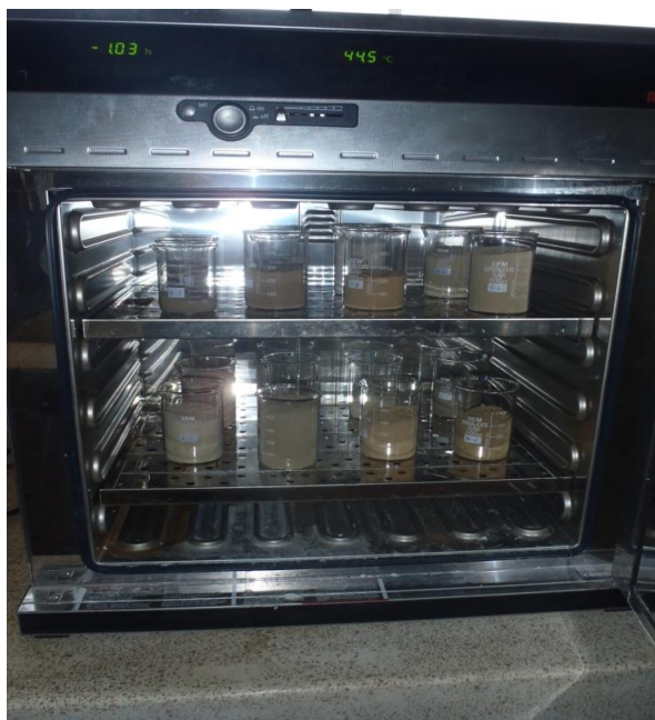
FOTO 2.2 PROCESO DE SECADO DE LAS MUESTRAS
