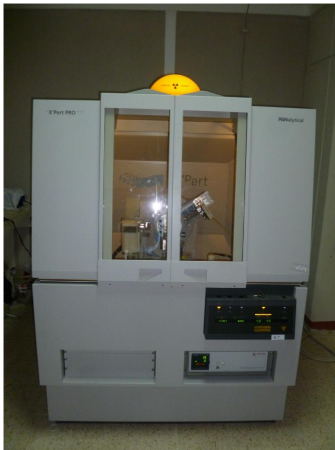
FOTO 2.6 EQUIPO DIFRACTÓMETRO DE RAYOS X
