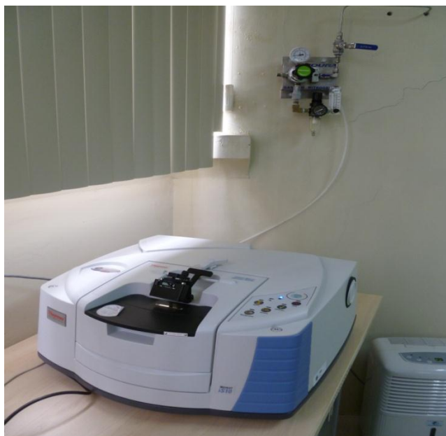
FOTO 2.8 EQUIPO ESPECTROMETRÍA INFRARROJO
