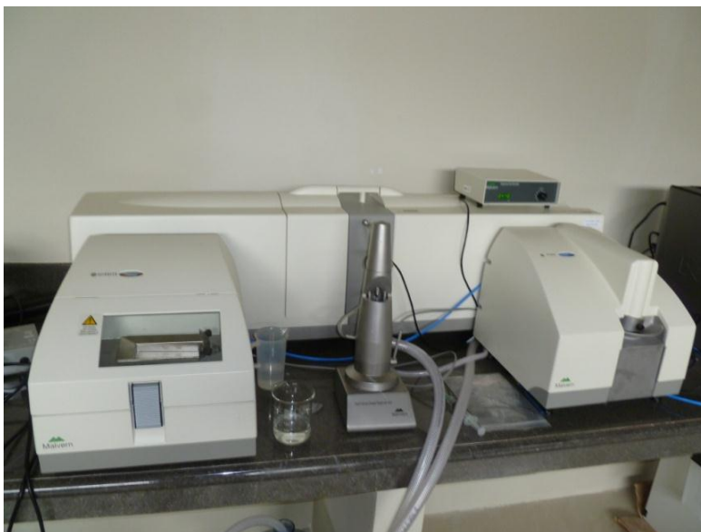
FOTO 2.5 EQUIPO ANALIZADOR DE TAMAÑO DE PARTICULA
