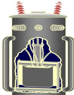
**FIGURA 3.1 Transformador**
