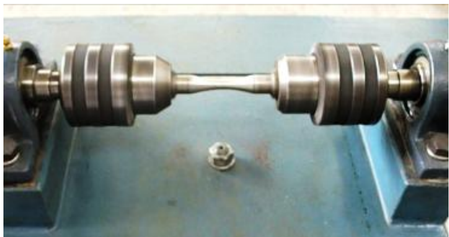
FIG. 3.5 FOTOGRAFÍA DE LA PROBETA MONTADA EN EL BANCO DE PRUEBAS
