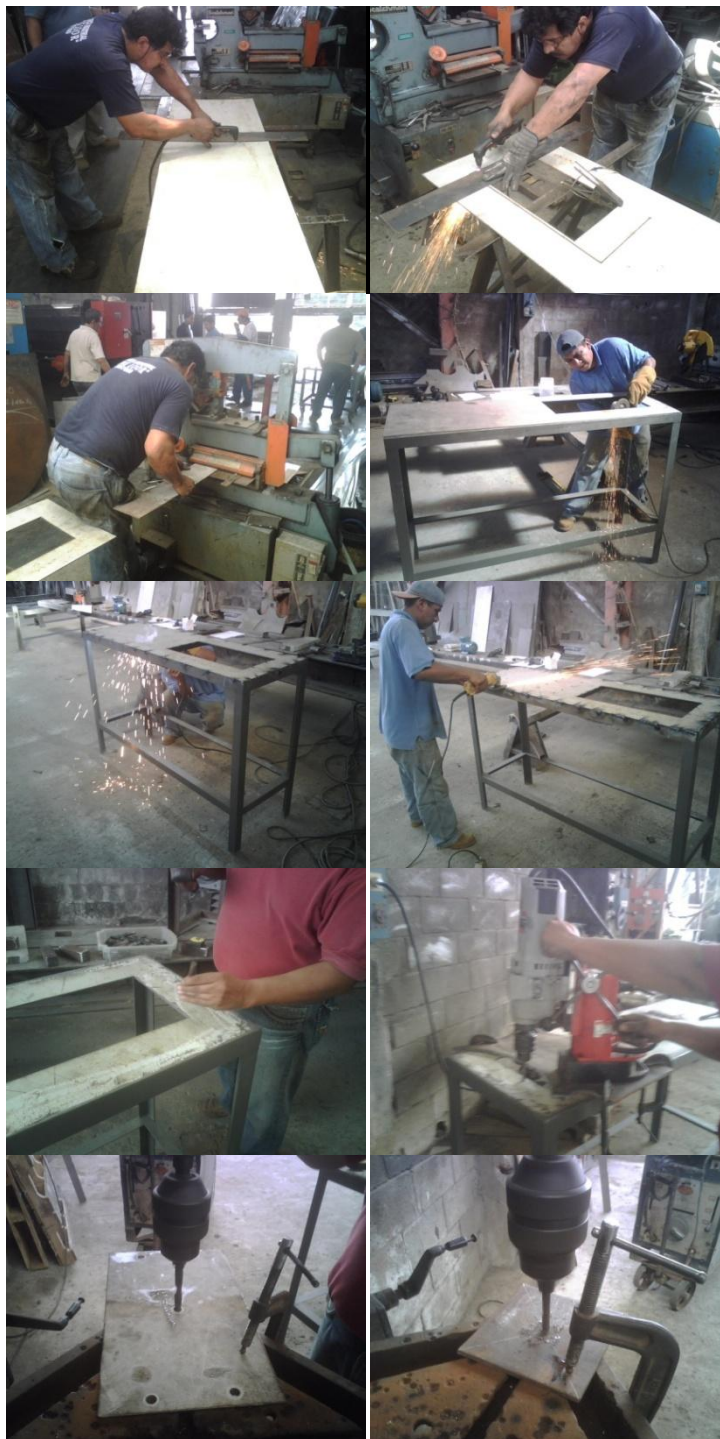
FIG. 2.11 PROCESO DE CONSTRUCCIÓN DE LASPLACAS
