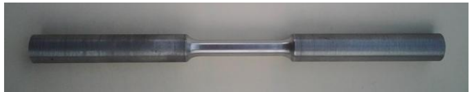
FIG. 3.1 FOTOGRAFÍA DE LA PROBETA PARA ENSAYO DE TRACCIÓN
