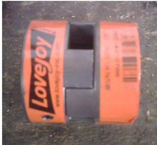
FIG. 2.4 FOTOGRAFÍA DEL ACOPLÉ SEMIFLEXIBLE
