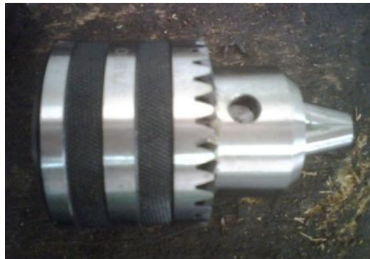
FIG. 2.7 FOTOGRAFÍA DE MANDRIL DE SUJECIÓN
