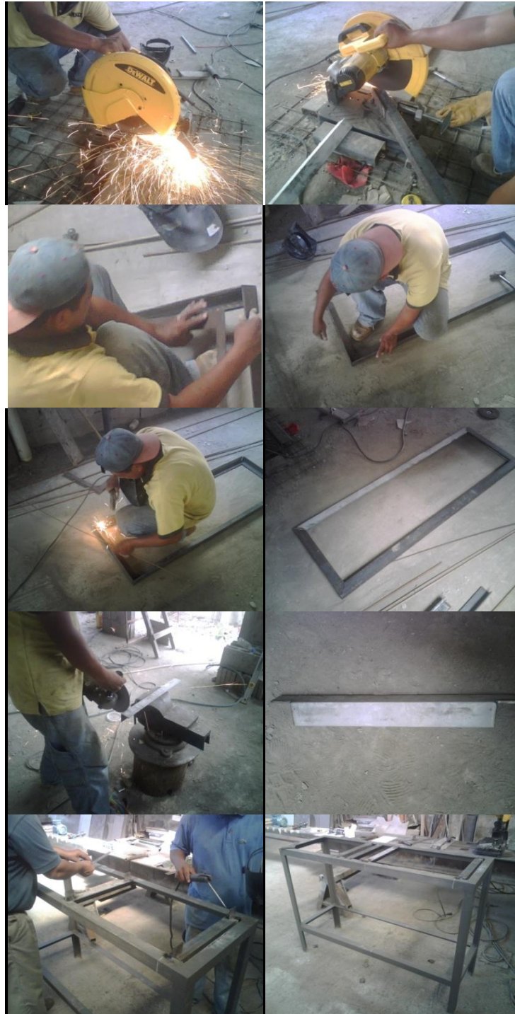
FIG. 2.10 PROCESO DE CONSTRUCCIÓN DE LA ESTRUCTURA METÁLICA
