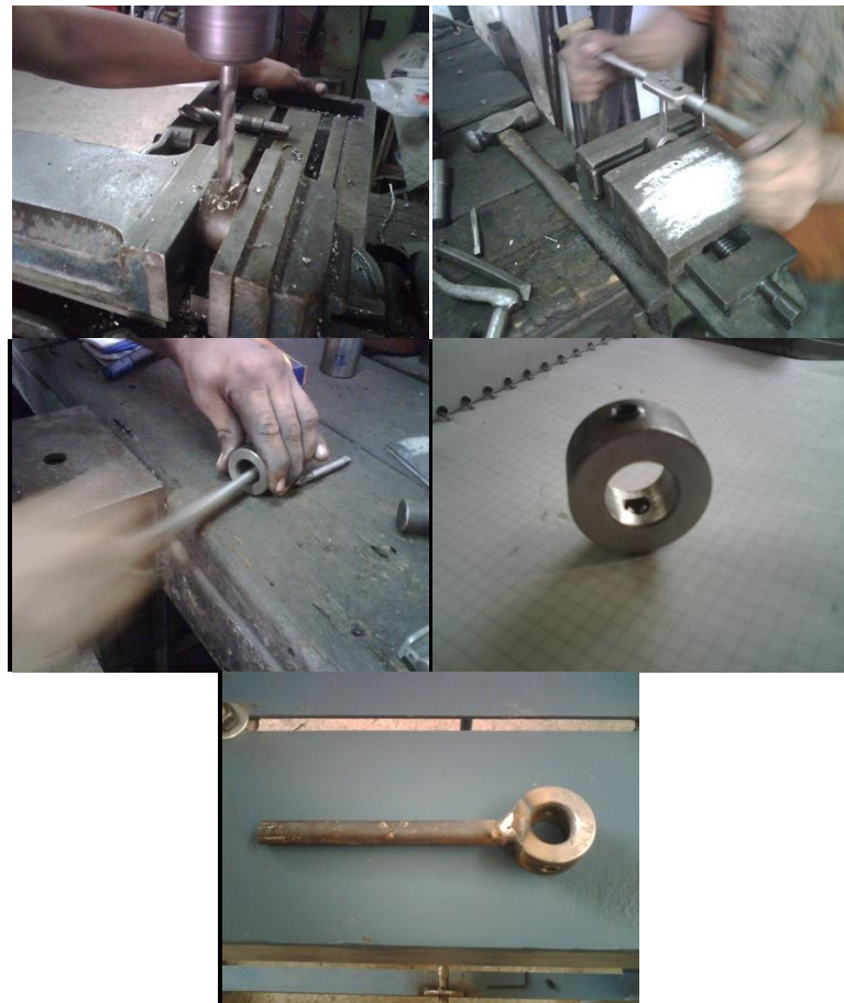
FIG. 2.18 PROCESO DE CONSTRUCCIÓN DE LAS PLACAS DE SOPORTE
