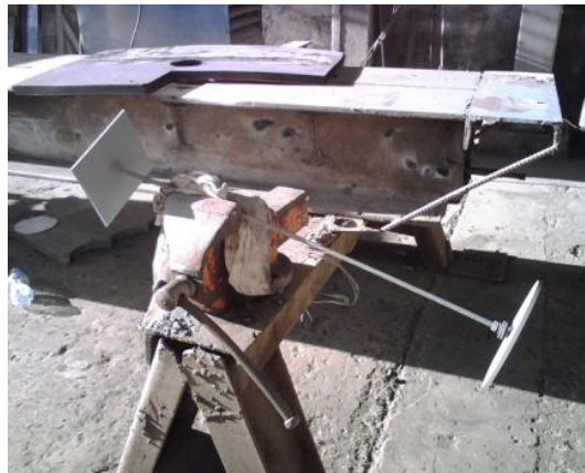
FIG. 2.13 FOTOGRAFÍA DE LA VARILLA DE CARGA TERMINADA
