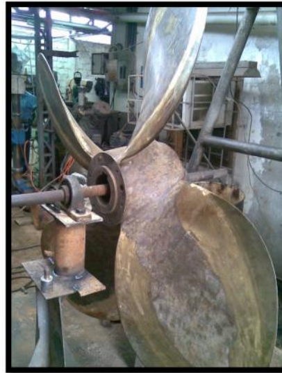
Figura N° 46. Balanceo estático de las hélices.
