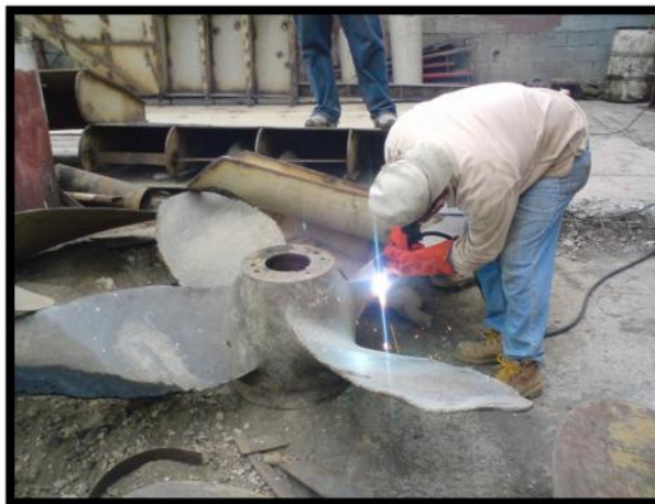
Figura N° 34. Corte de las palas de la hélice del remolcador antes de la modificación.
