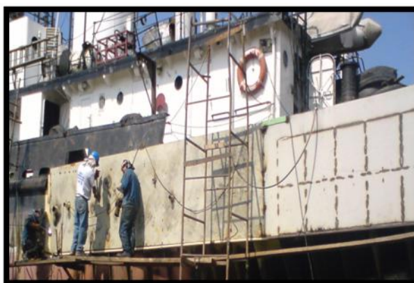
Figura N° 9. Montaje del planchaje de costado.
