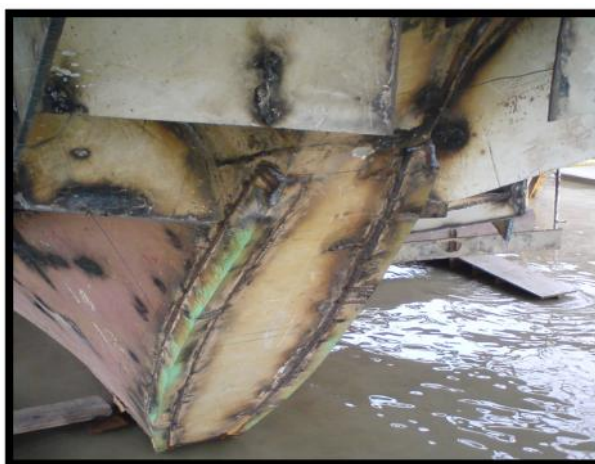
Figura N° 3. Corte y sellado del codaste central.
