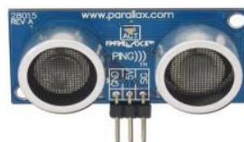
Fig. 1.4. Sensor de distancia
