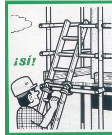
Fig.1. 13 Escaleras de acceso a andamios
