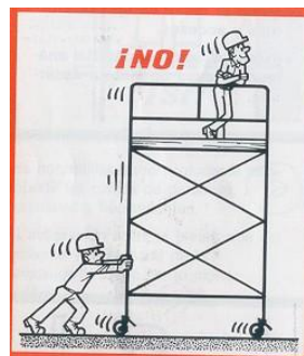
Fig.1. 10 Uso de barandas en andamios
