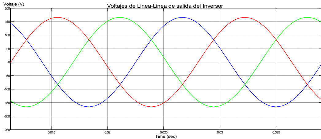
Figura 3.31: Simulación de los Voltajes de Línea-Línea de salida del Inversor, hecho en Simulink
