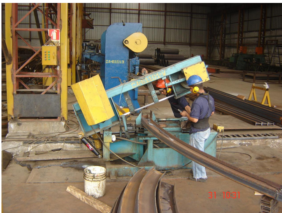
Figura 1.1.16 Corte por sierra de vigas
