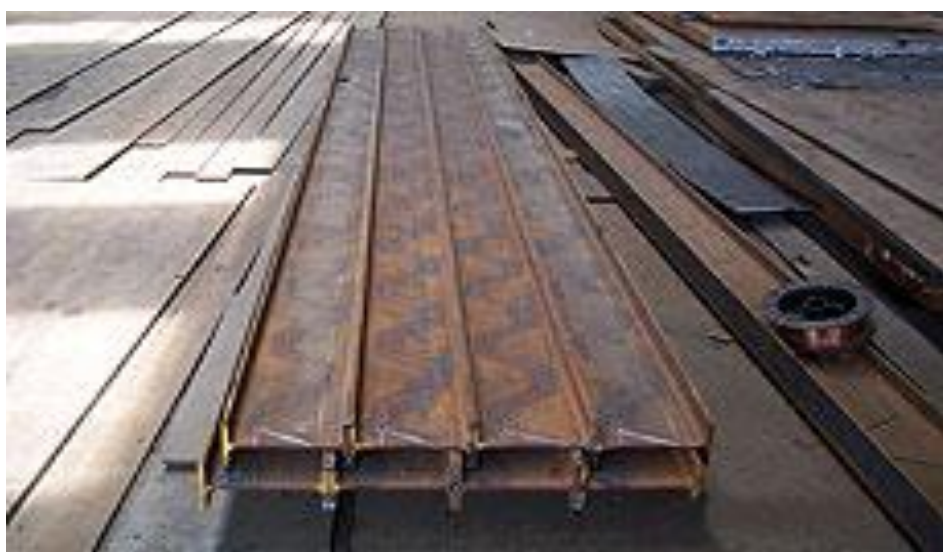
Figura 1.1.11. Corte de vigas boyler
