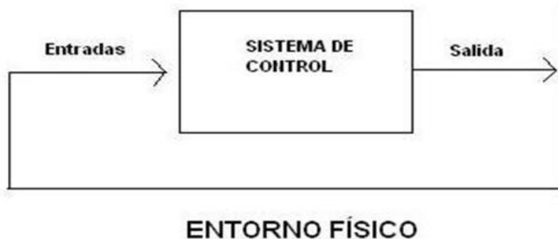
Figura2.13 Entorno físico de sistema de control
