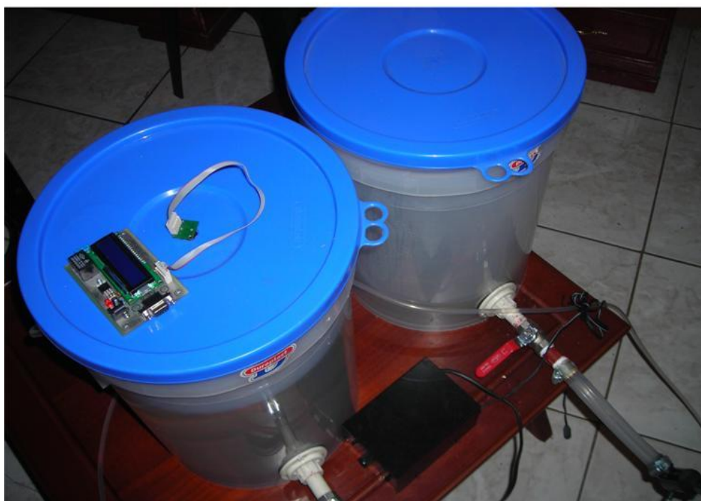
Figura 4.7 Montaje de tanque sensor
