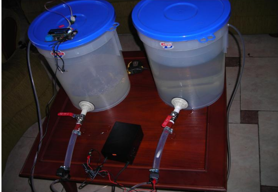
Montajes de Tanque Sensor
