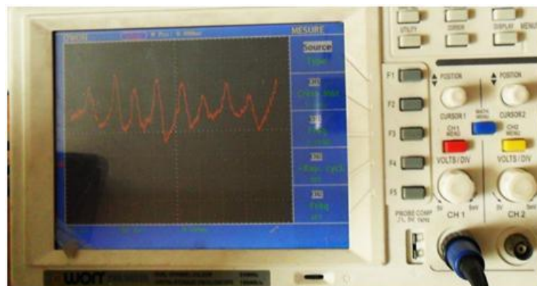
Figura 4.1.- Señal EEG en un osciloscopio
