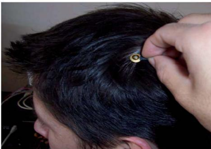
Figura 3.15.- Montaje del electrodo en el cuero cabelludo
