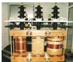
Figura 1.3. Transformador en aceite
