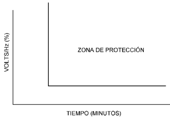
Figura 4.23 Característica típica del relé de tiempo definido.
