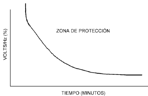
Figura 4.24 Característica típica del relé de tiempo inverso.
