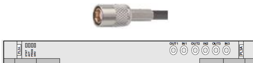
Figura 5.18 Tarjeta de procesamiento PDH N1PL3A y conector SMB [13].
