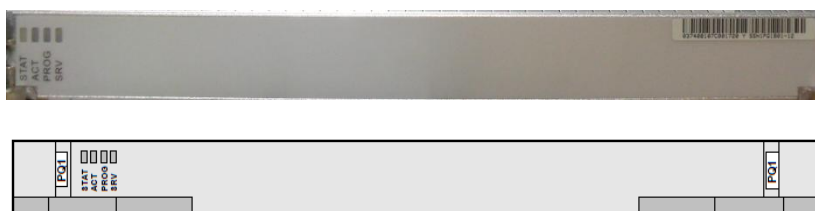
Figura 4.12 Vista frontal de la tarjeta N1PQ1B [13].
