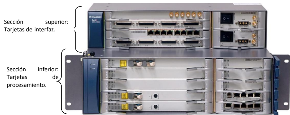
Figura 4.1 Secciones del OSN 1500B [12].
