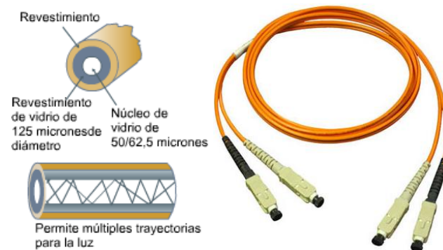
Figura 4.22 Fibra óptica Multimodo.
