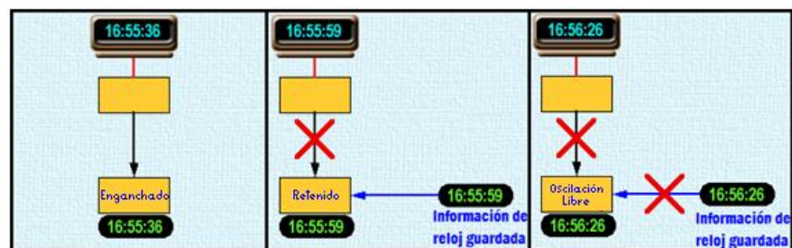
Figura 5.3 Modos de operación de equipos esclavo.
