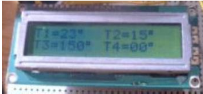
FIGURA 1.3.- En el LCD se muestran los 4 canales T1=RA0, T2=RA1, T3=RA2, T4=RA5.
