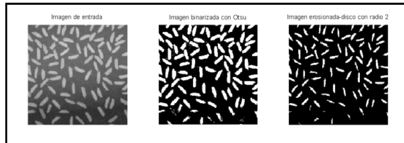
Ilustración 7 Ejemplo gráfico de la operación erosión
