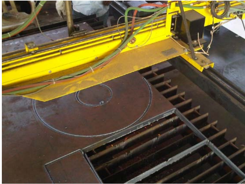
Figura A.8 La pieza cortada con la misma geometría y escala del dibujo
