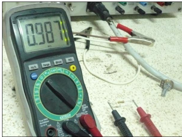
FIGURA 2.19.- MONITOREO DE LA RESISTENCIA CON MULTÍMETRO DIGITAL.
