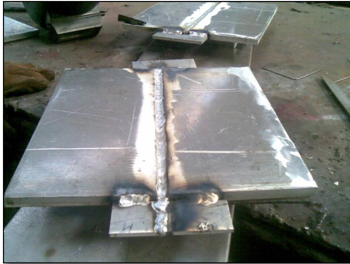
FIGURA 2.4.- FOTOGRAFÍA DEL PRIMER PASE
