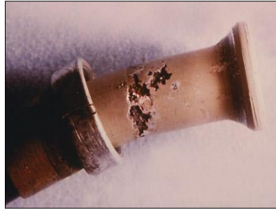
FIGURA 1.13.- FOTOGRAFIA DE TUBERÍA DE ALUMINIO DE UN CIRCUITO HIDRÁULICO
