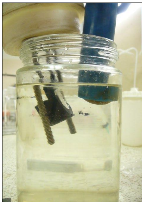
FIGURA 2.8.- ELECTRODO DE REFERENCIA Ag/AgCl Y CONTRAELECTRODOS INOX 304.
