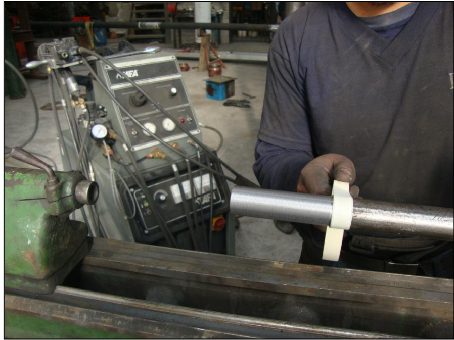
Figura 3.12: Protección del área adyacente a ser rociada
