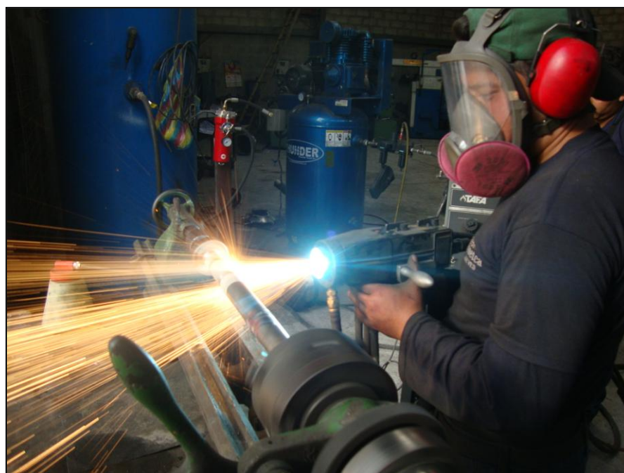
Figura 3.13: Aplicación del alambre base BOND ARC 75B
