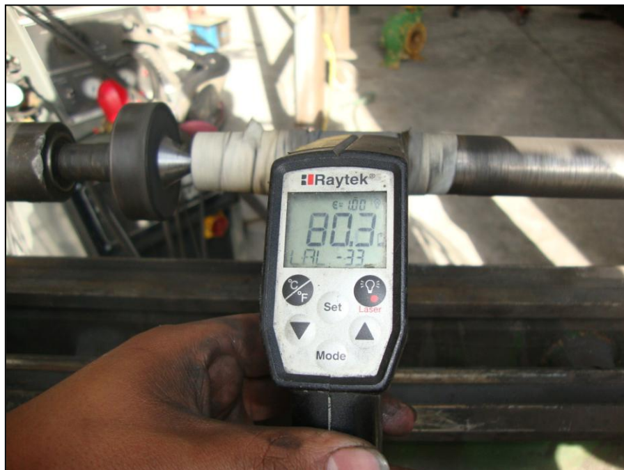
Figura 3.17: Control de temperatura durante el rociado
