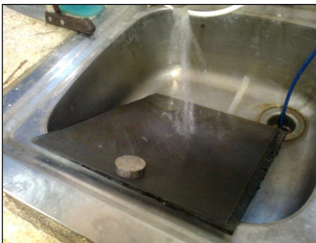
Figura 3.1: Muestra sumergida en agua para el desbaste
