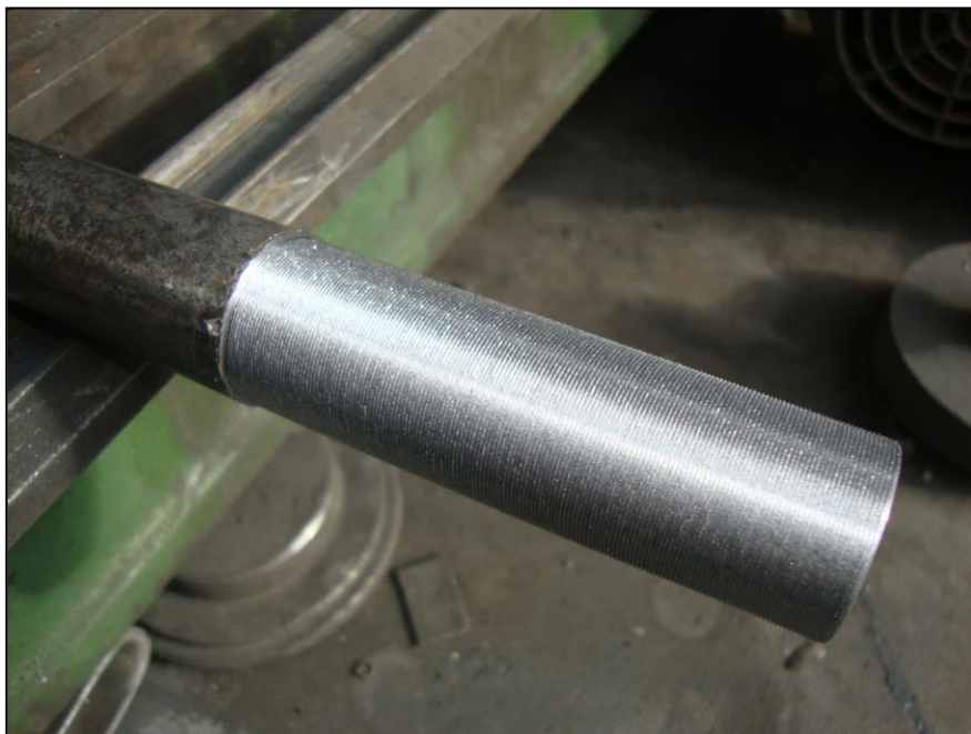
Figura 3.11: Eje completamente roscado en el torno en el área a metalizar
