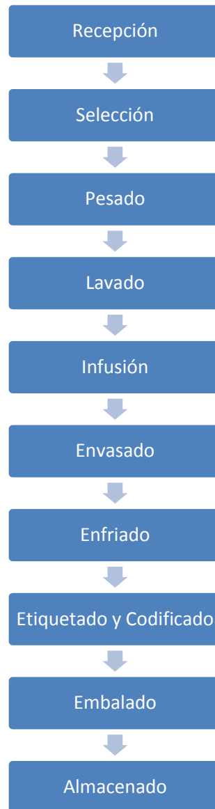
FIGURA 1.19 DIAGRAMA DE FLUJO GENERAL PARA LA ELABORACIÓN DE LA BEBIDA HORCHATA EMBOTELLADA
