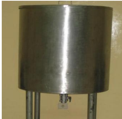
FIGURA 3.16. TANQUE DE LAVADO
