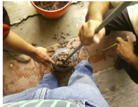
Figura 4.14 Varillado de las capas
