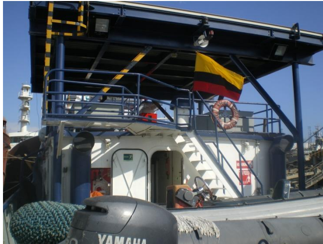
FIGURA 1.20 VISTA A POPA DE LA SUPERESTRUCTURA SE APRECIA EN PARTE SUPERIOR EL HELIPUERTO
