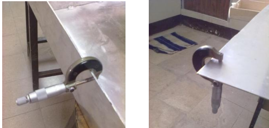
Figura No. 23 Medición de espesores del ala y alma
