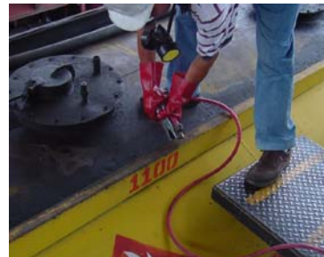
8.- Conectar la pinza del auto tanque a tierra.
