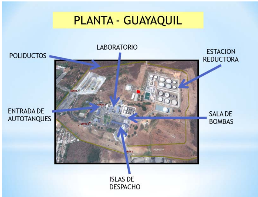
FIGURA 3.1: DESCRIPCIÓN DE LAS INSTALACIONES
