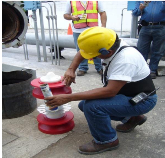
Figura 2.6.- Herramienta de flujo magnético empleada en el estudio
