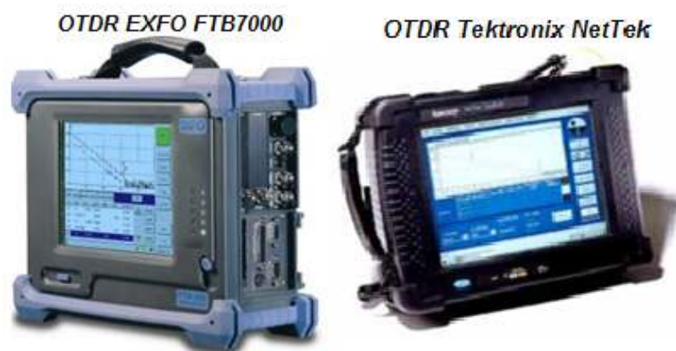
Figura 1.22 Equipos OTDR utilizados para las mediciones de tramos
