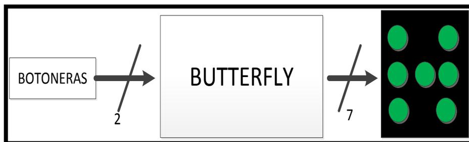
Figura 4.1 Diagrama de Bloque dados electrónicos
