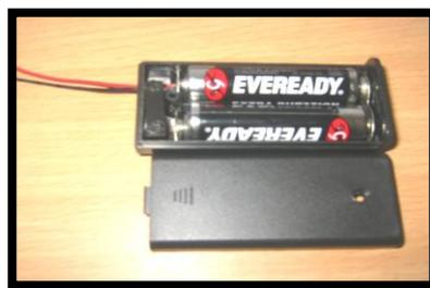
Figura 2.13 Baterías AA de 1.5 V y porta-baterías
