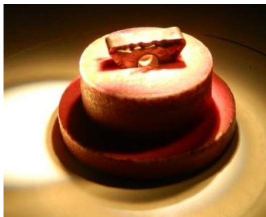
FIGURA 2. 7 DISPOSITIVO DE SUJECIÓN DEL INSERTO.
