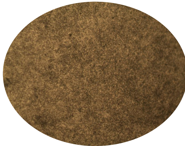
FIGURA 1.8 METALOGRAFÍA DE MATERIAL DE LA PIEZA DE TRABAJO AISI 01 100X.
