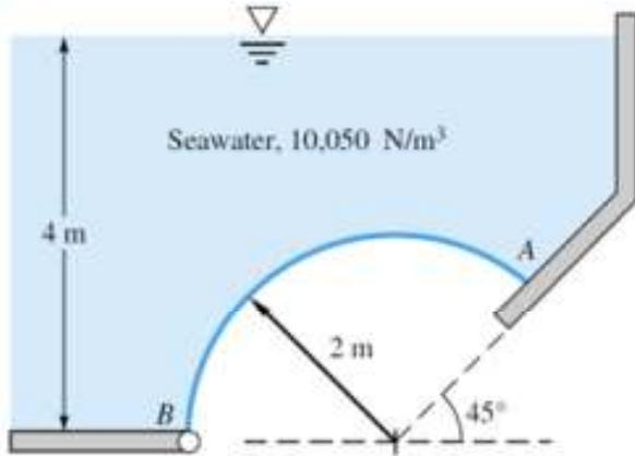
1. En la figura adyacente, la compuerta AB es una superficie con un perímetro curvo que corresponde a  $\frac{3}{8}$  de círculo. Esta compuerta tiene 3 metros de ancho perpendicular al plano de la figura. El punto B corresponde a una bisagra (pivote) y el punto A descansa sobre una pared suave. Calcule las fuerzas de reacción en A y B. El líquido que produce la presión es agua de mar con un peso específico de  $10050 \text{ N/m}^3$  (14 PUNTOS) USAR 3 DECIMALES
