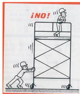
Fig.1. 10 Uso de barandas en andamios
