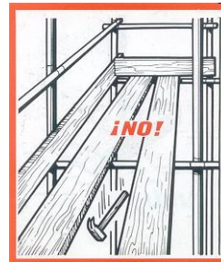
Fig.1. 11 Piso en andamios con tablonos de madera
