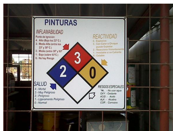
Fig.1. 18 Tipo de Sustancias y Peligros
