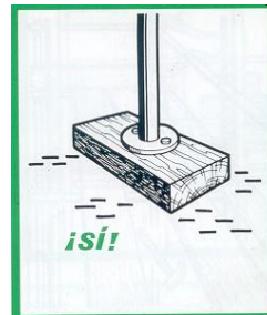
Fig.1. 8 Apoyos de maderas para andamios
