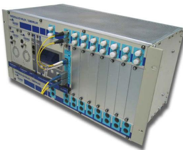
Figura 3.1 - Tarjeta Controladora OLT EPON insertada en chasis SAE-2002-5UA. (10)
