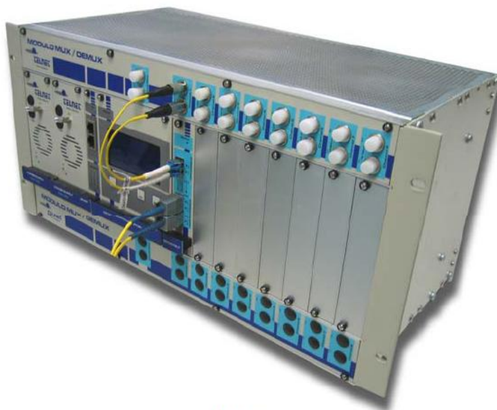
Imagen: tarjeta controladora OLT EPON insertada en chasis SAE-2002-5UA
