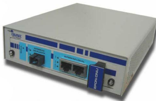
Figura 3.2 - Tarjeta ONU EPON insertada en chasis MicroSAE/220AC. (10)
