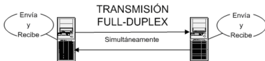
Figura 2.3 Comunicación serial: Full Duplex
