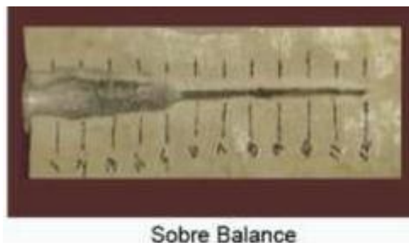
Figura 2.8 Disparos en sobrebalance Fuente: Halliburton
