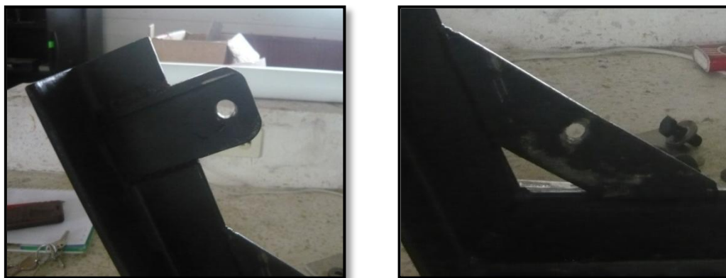
Figura No. 32 Orejas de la base con orificios para pernos
