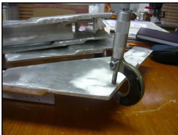
Figura No. 28 Medición de espesores del alma, ala y escuadra
