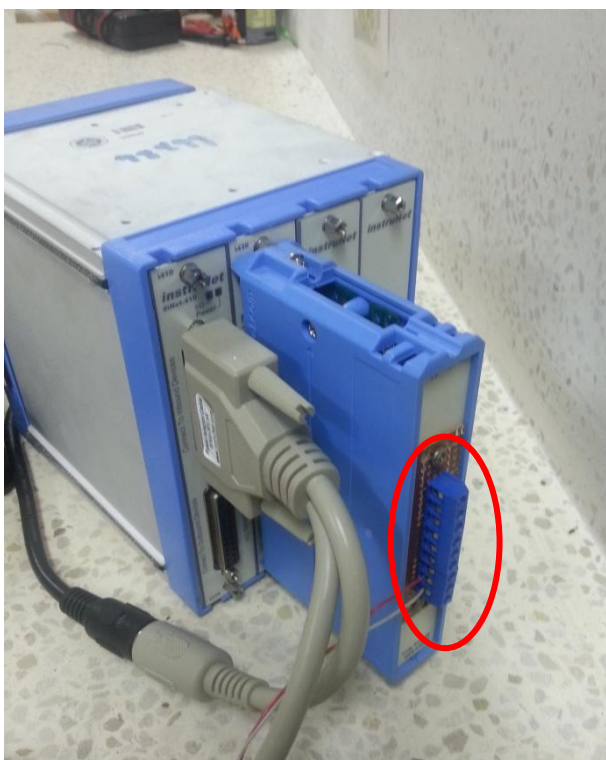
Figura No. 88 Terminal de Tornillo adaptada al equipo
