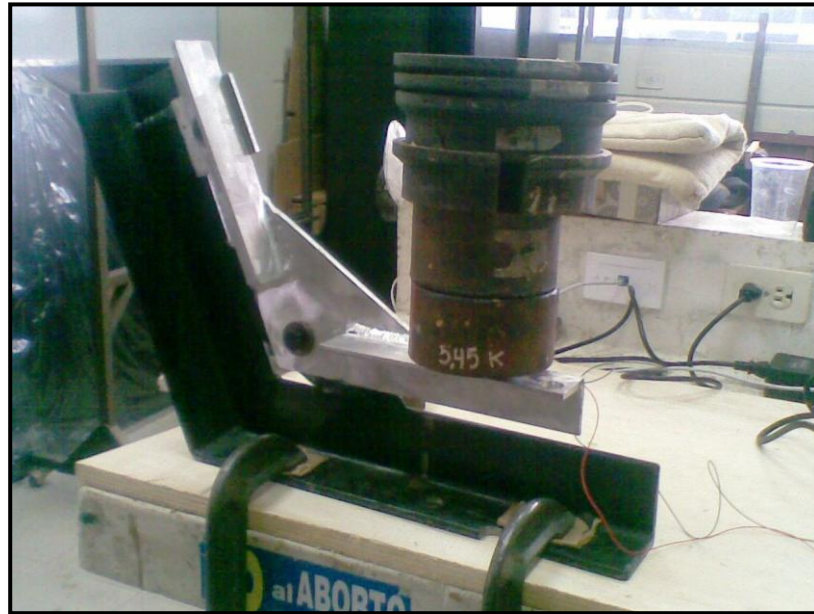
Figura No. 33 Aplicación Preliminar de carga concentrada
