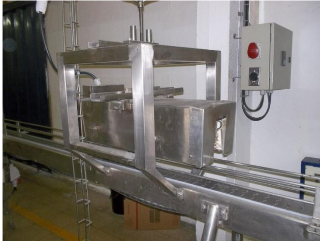
Fig.3.43. túnel de termoformado y panel de control
