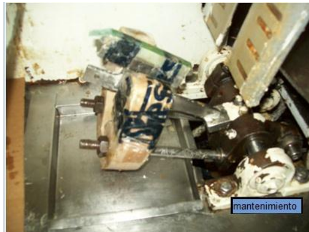
Fig.3.29. Mecanismo posicionador de etiquetas
