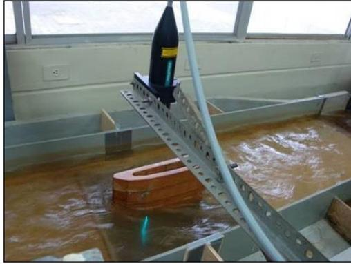
**Figura #9.-** Probeta del equipo LDA
