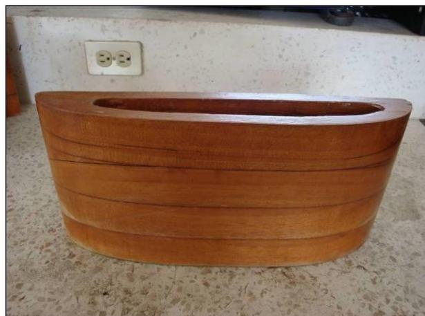
Figura 7.- Modelo de sección transversal de una tobera real
