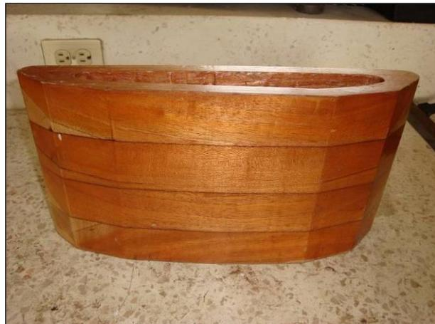
Figura 11.- Modelo de sección transversal de una tobera segmentada
