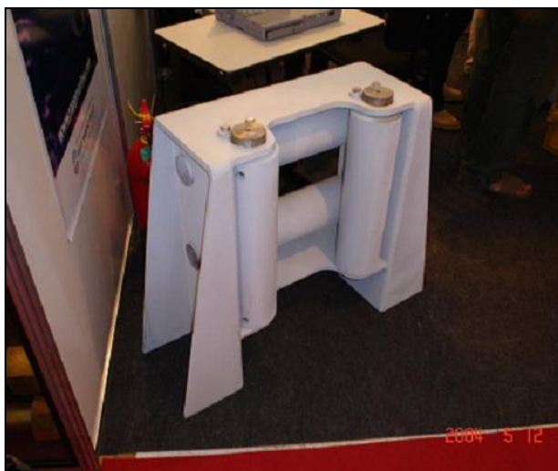
Figura 2.5.- Fairlead, guía para cables. [18].
