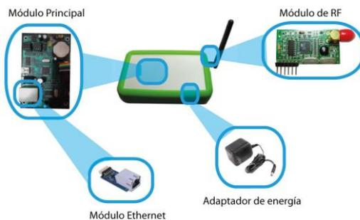
Figura 5.2 Componentes del Concentrador
