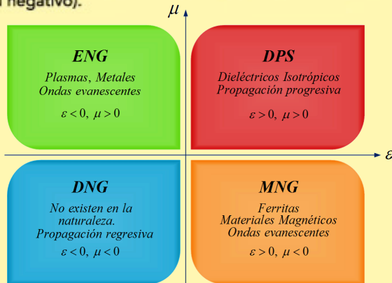
Figura No. 1 Caracterización de los materiales de acuerdo a los valores de sus permitividad y permeabilidad
