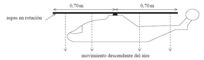
a) Las aspas en rotación del helicóptero hacen que una columna de aire se mueva hacia abajo. Explique cómo esto hace posible que el helicóptero permanezca quieto. (3 puntos)
