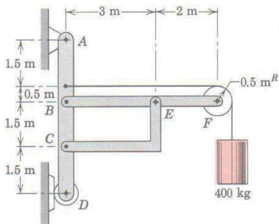
Encontrar las fuerzas horizontales y verticales existentes en cada uno de los elementos del armazón mostrado. Desprecie el peso de los elementos del armazón.
