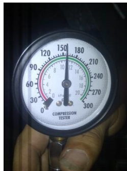
Figura 3-19 Como ejemplo, la lectura del man3metro para el cilindro #1.
