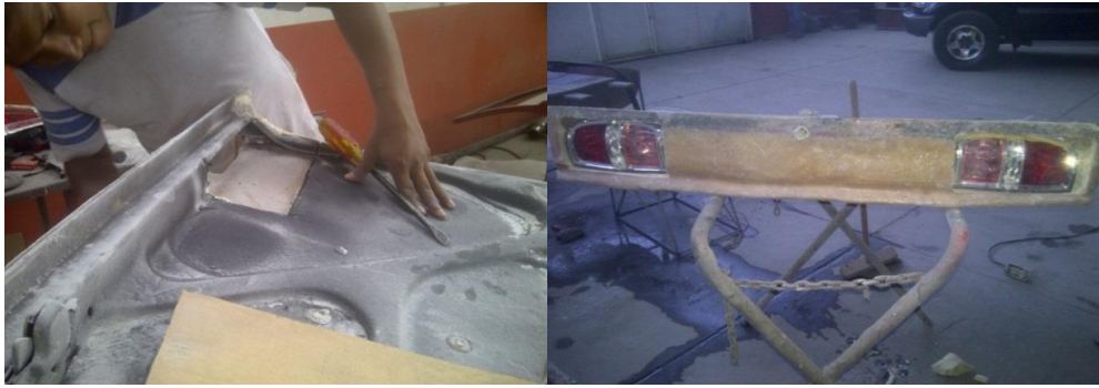
Figura 5-15 Colocación de guías posteriores.
