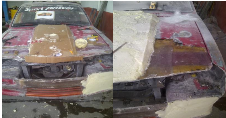
Figura 5-7 Creaci3n de molde para capot delantero.
