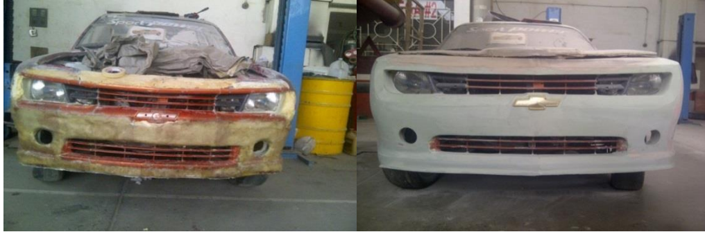
Figura 5-11 Modificaci3n de mascarilla y parachoques delantero.
