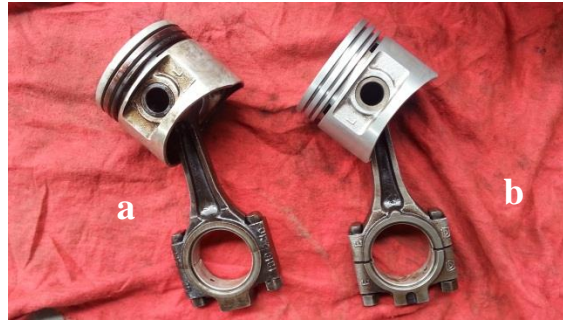
Figura 3-14 El antes (a) y el despu3s (b) de la limpieza de un pist3n y brazo de biela.
