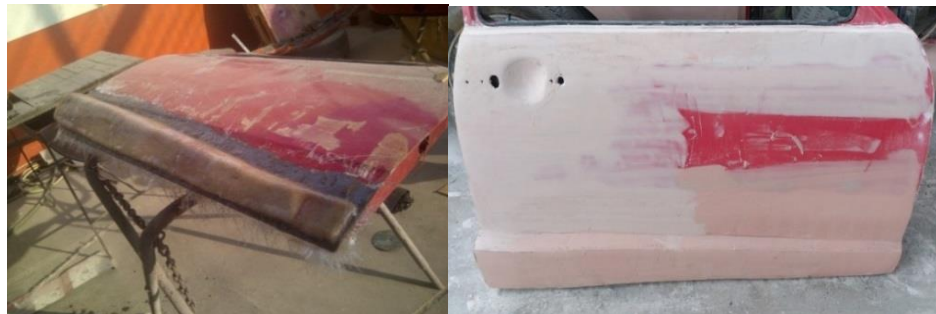
Figura 5-13 Construcci3n de molde para puertas y t3neles.
