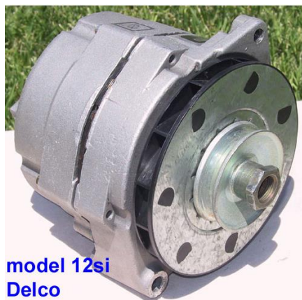
Figura 4-12 Alternador Delco Remy 12V 95 A
