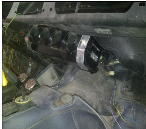
Figura4-18 Consola del evaporador adaptada.
