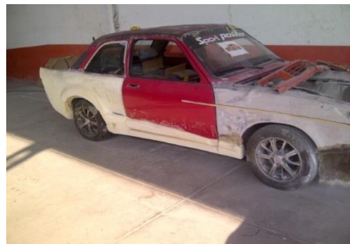
Figura 5-4 Construcci3n de molde para puertas y t3neles.
