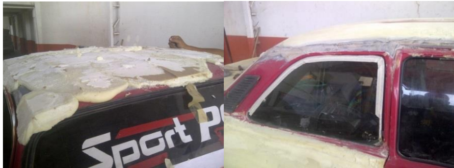
Figura 5-9 Molde del techo.
