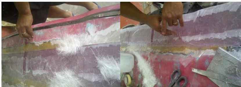
Figura 5-6 Proceso de creaci3n de molde para capot delantero.
