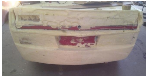
Figura 5-3 Molde parachoques posterior.
