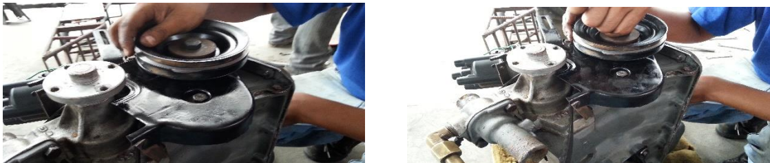
Figura4-15 Polea doble instalada en el cigüeñal.
