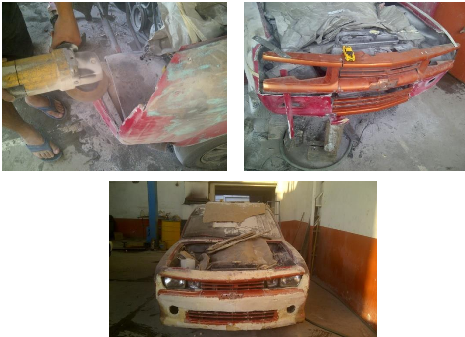
Figura5-2 Molde para mascarilla y parachoques delantero.
