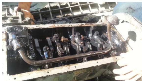
Figura 3-8 Parte inferior e interior del bloque de cilindros. Con el c3rter desmontado.
