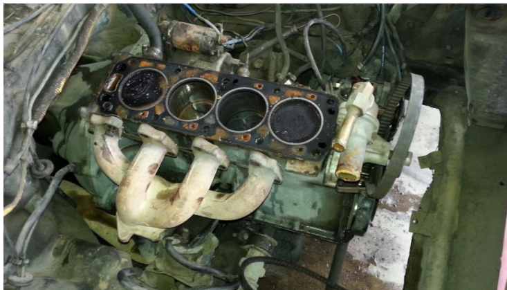
Figura 3-3 Estado del bloque de cilindros en su uni3n con la culata.
