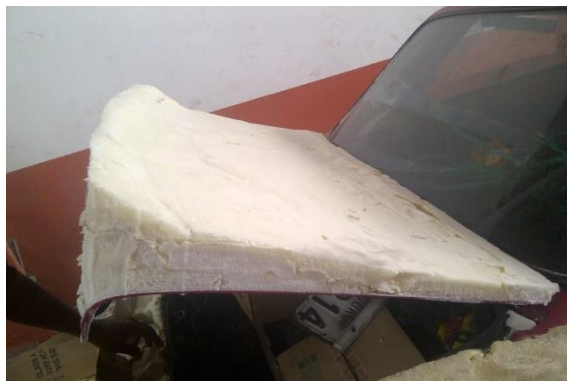
Figura 5-8 Molde del capot posterior.
