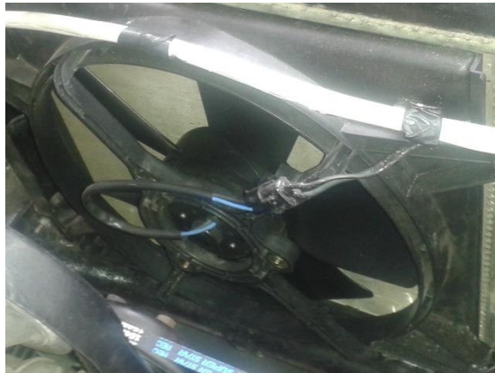
Figura 4-14 Ventilador del Radiador.
