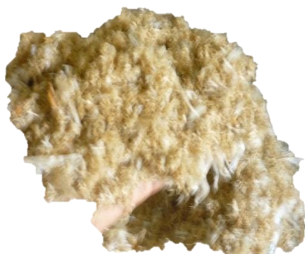
Figura 10°10 Plástico cortado pero no aglutinado.
