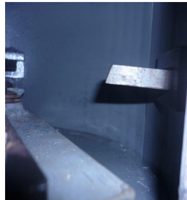
Fig. 5°8 Montaje de las cuchillas.
